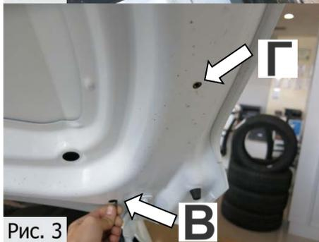
3. Держась за проволоку, завести планку закладную в отверстие (В) в усилителе капота. Совместить резьбовое отверстие планки с отверстием Г, (Рис.3).
