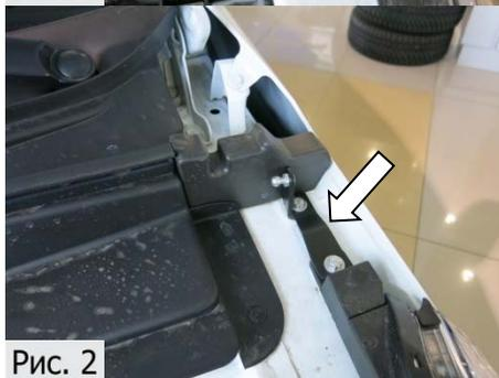
2. Установить кронштейн, зафиксировав его двумя болтами М6х25 с шайбами 6. Сдвинуть кронштейн до упора к лобовому стеклу и крылу. Затянуть болты торцевой головкой №10 с усилием 9 Нм, (Рис.2).
