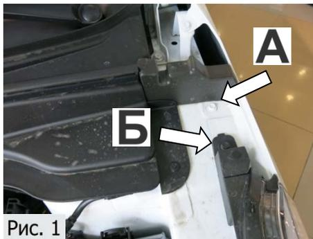
1. Торцевой головкой №10 выкрутить болт крепления крыла (А) и болт крепления фары (Б), (Рис.1).
